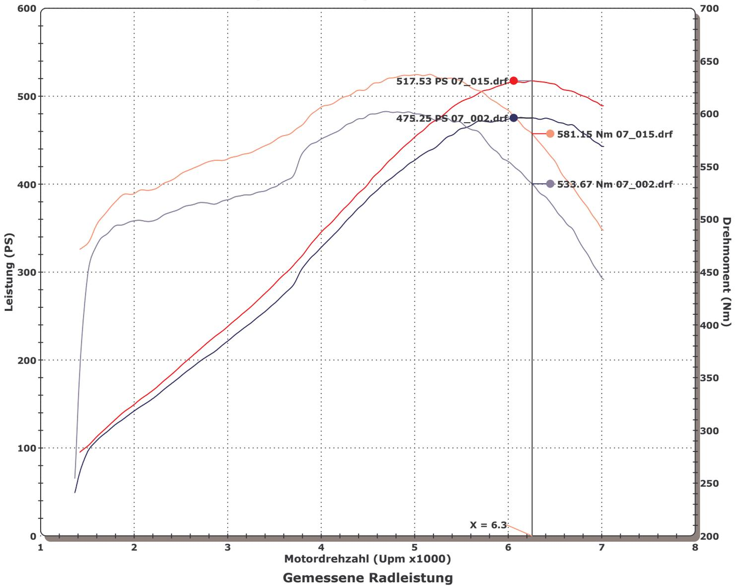
07\_002.drf - 29.02.2008 14:44:24 Testlauf: RO Run Conditions: 22.20 °C, 970.08 Mbar, Luftfeuchte: 42%, DIN: 1.05
